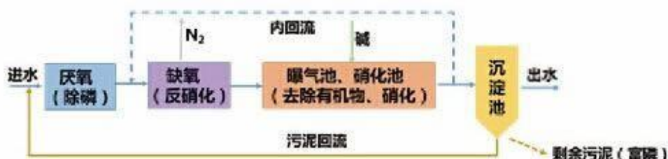
附图 13 A 2 O 生活处理工艺流程图
